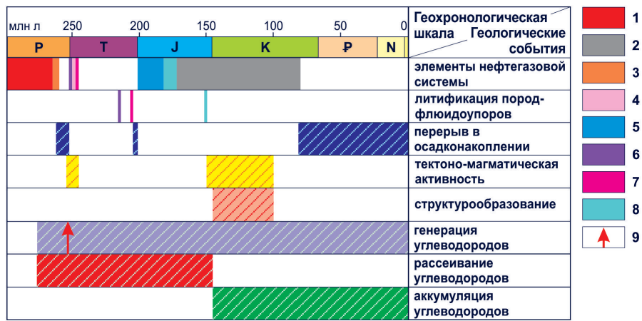
Рис. 6. Диаграмма геологических событий для верхнепалеозойско-мезозойской нефтегазовой системы Хатчагайского мегавала Вилюйской гемисинеклизы: 1 – пермская газоматеринская толща; 2 – перекрывающие отложения; 3 – таргайский, 4 – таганджинский, 5 – кызылсырский коллекторы; 6 – нежелинский, 7 – мономский, 8 – сунтарский флюидоупоры; 9 – критический момент (значения коэффициента трансформации керогена достигли 50 %)
