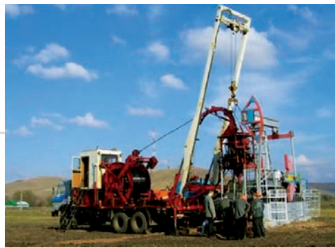
Рис. 3. Обработка ПЗП кислотным составом ИТПС-РС марки «А». Недостатки НС1 15 МЛ, НС1 24МЛ: длительное реагирование кислоты, высокая скорость реакции. Преимущества ИТПС-РС марки «А»: кислота замедленного действия, длительный срок эффекта от обработки, высокая успешность.
