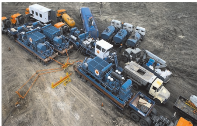
Рис. 1. Процесс проведения гидроразрыва пласта.
