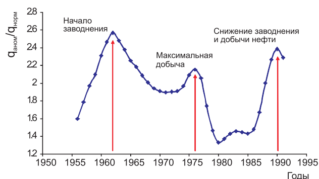
Рис. 2. Динамика отношения средних дебитов аномальных скважин к средним дебитам нормальных скважин Миннибаевской площади за 40 лет их эксплуатации.
